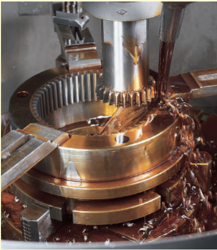
使用 CNC 插齿机加工内齿轮轮齿
